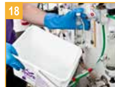
18 Bleed fob detectors & rinse bleed tube
